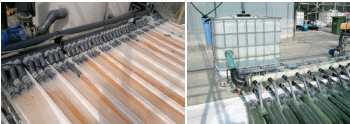
Figuur 51. Algen fotobioreactoren bestaande uit horizontale transparante buizen op het teeltoppervlak van een kas zoals geïnstalleerd bij de tuinbouwonderneming Newplant (links) en bij het bedrijf LGem (rechts)
