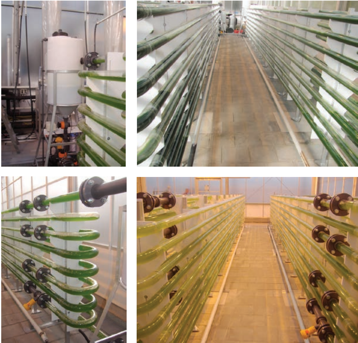
Figuur 15. Proeffaciliteit algenteeltsystemen in een kas bij Wageningen UR Glastuinbouw in Bleiswijk bestaande uit zes verticale algenbuisreactoren.
