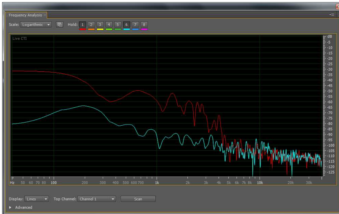
Figuur 19: Verspreiding van akoestische energie van het geluid dat werd uitgestoten door Heien (rode lijn) over het gemeten frequentiebereik in vergelijking tot het normale achtergrondgeluid (blauwe lijn) . De x-as beschrijft de frequentie (logaritmische weergave), de y-as het ontvangen niveau (in dB). De verschillende kleuren duiden op metingen op verschillende momenten in de tijd.
