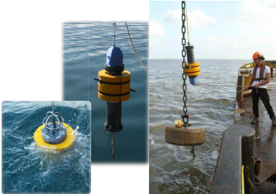
Figuur 4. De geluidsrecorders (AMAR G2 meest linkse en middelste foto: JASCO Applied Sciences) en de AMAR-opstelling in de Eems (rechtse foto).
