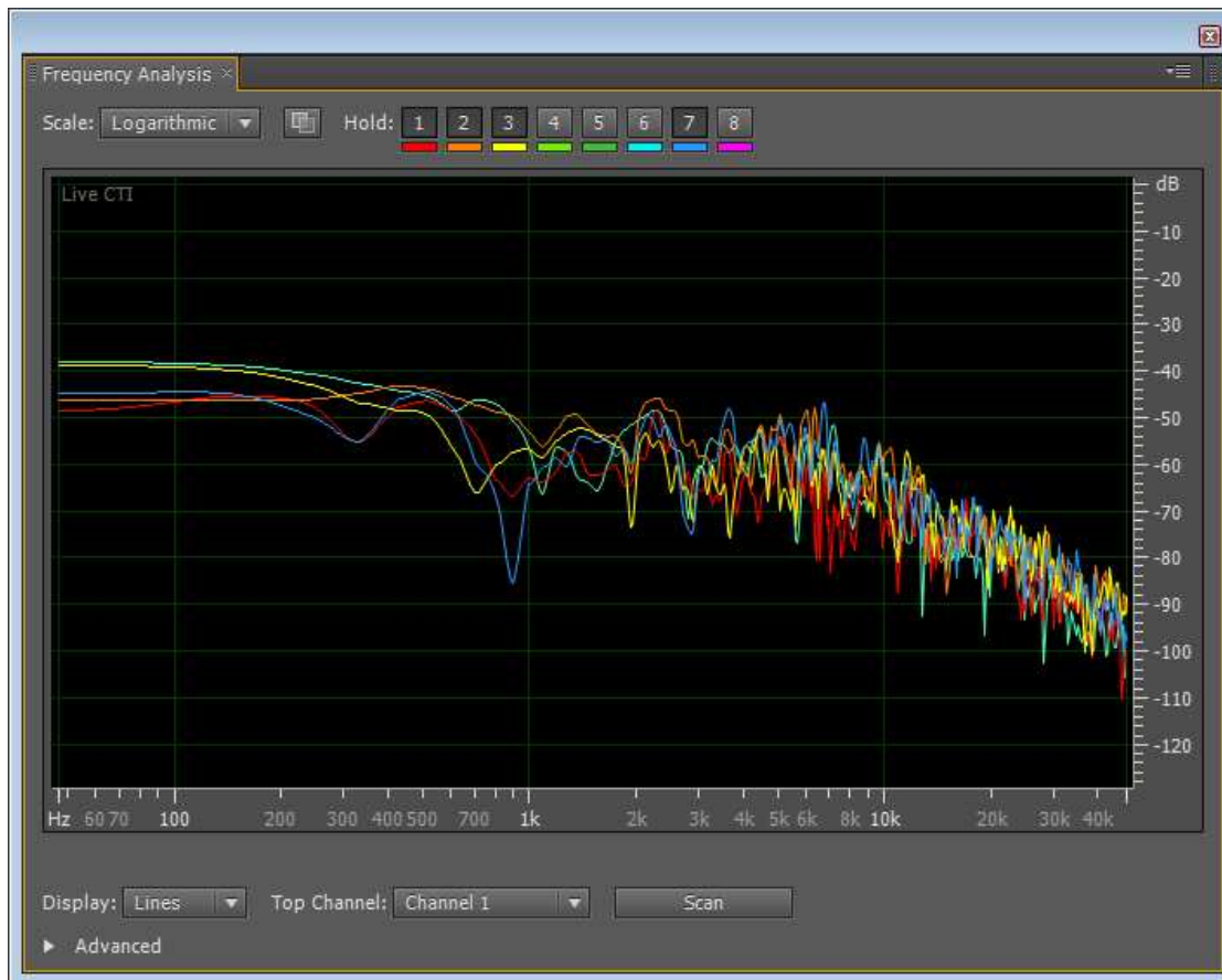
Figuur 29: Verspreiding van akoestische energie van het geluid dat werd uitgestoten door Damwand Trillen over het gemeten frequentiebereik. De x-as beschrijft de frequentie (logaritmische weergave), de y-as het ontvangen niveau (in dB). De verschillende kleuren duiden op metingen op verschillende momenten in de tijd.
