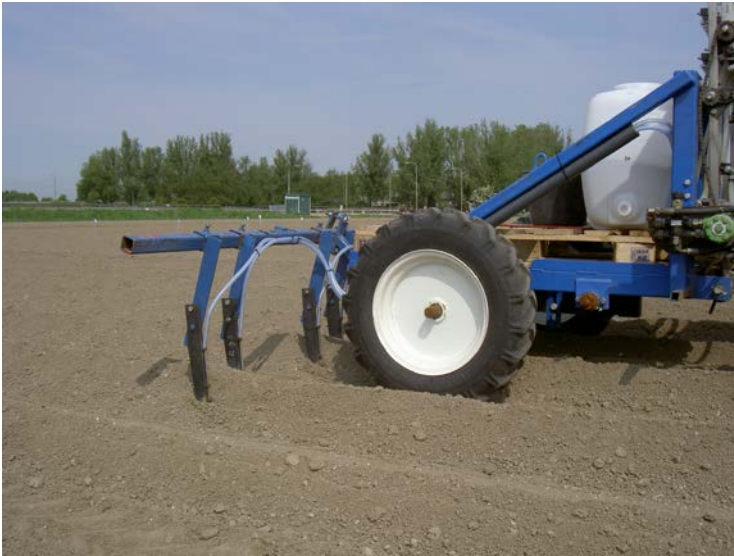
Figuur 2. Rijenbemester van NCOR , gebruikt voor rijenbemesting in werking
