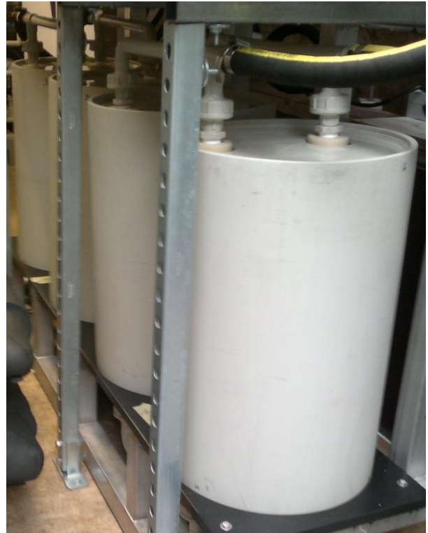
Figuur 7 spiral wond membraandestillatie modules gebruikt in het pilot-onderzoek
