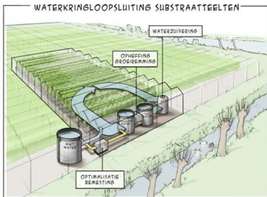
Figuur 1 Opzet project Glastuinbouw Waterproof – substraatteelt: waterkringloopsluiting bij substraatteelt glastuinbouw bedrijven door onderzoek naar waterkringloopsluiting door optimaliseren van nutriënten dosering, opheffen van groeiremming en waterzuivering
