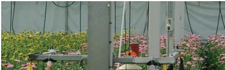
Figuur 5. De twee PAR sensoren zitten links en rechts van de kaspoort.
