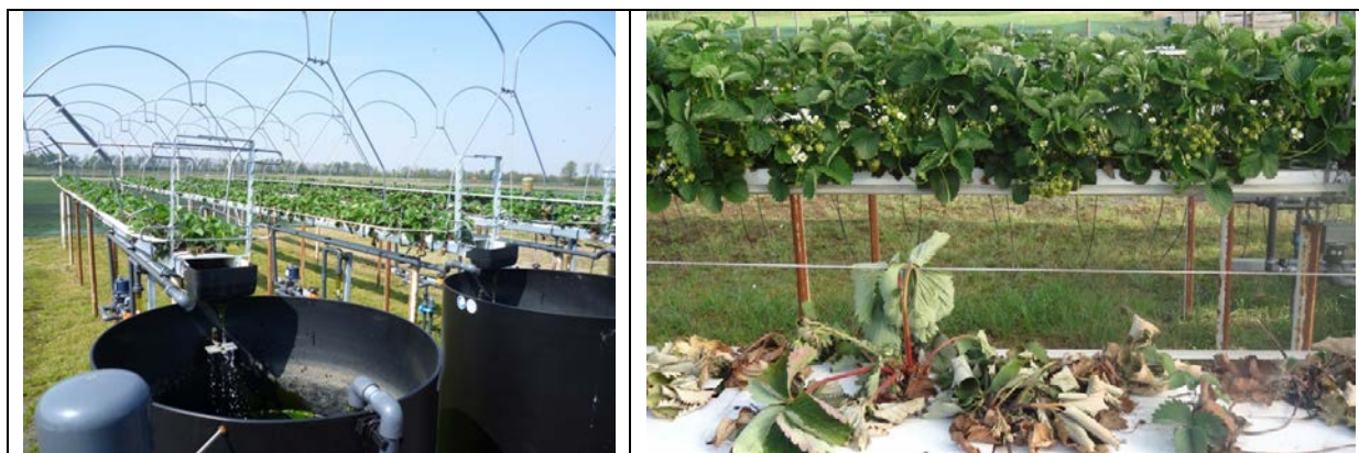
Figuur 3. Links proefopstelling van een langzaam zandfilter op PPO Vredepeel; rechts op de voorgrond aardbeiplanten aangetast door Phytophthora (onbehandeld), daarachter aardbeiplanten die één maal behandeld zijn met Paraat.
