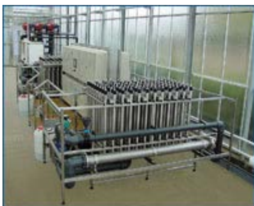
Figuur 4. Lage druk UV-ontsmetter gebruikt bij recirculatie bij de teelt van aardbeien onder glas.
