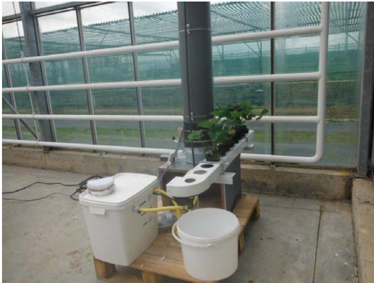
Figuur 9. Opstelling waarmee de effectiviteit van het langzaam zandfilter op afdoding van Xf in drainwater is getoetst.
