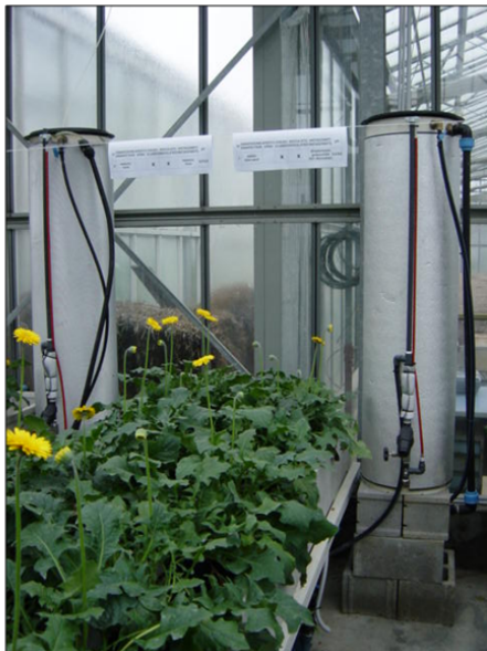
Figuur 2. Links een proefopstelling van een langzaam zandfilter, rechts een schematische weergave.
