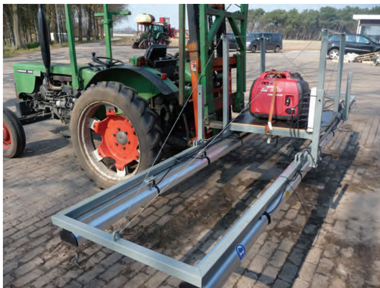
Het eerste prototype van de UV-machine voor aardbeien, eind 2011.
