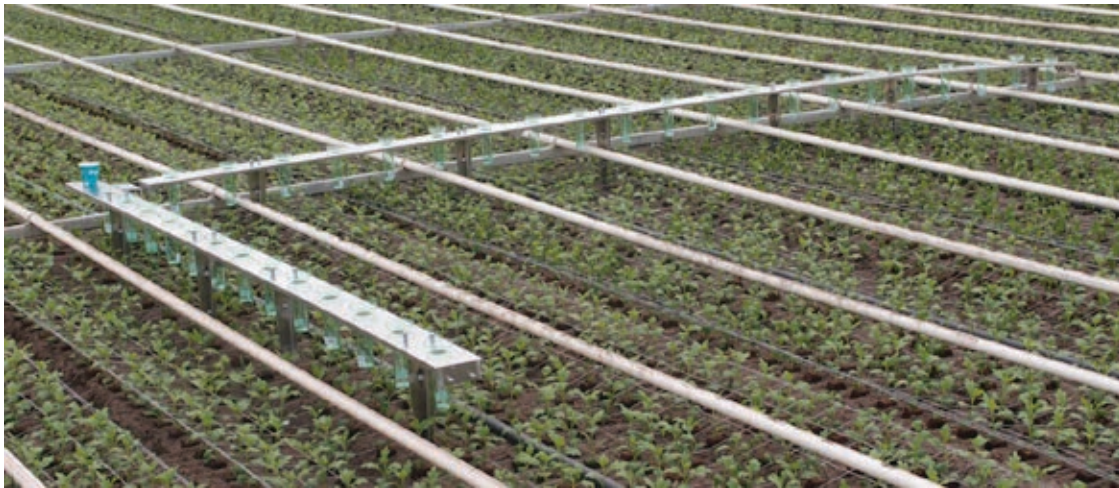
Figuur 12. verbeterde meetopstelling met regenmeters.
