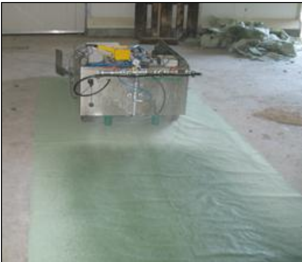
Foto van de autonoom rijdende oliefilmrobot op een traject van kuikenpapier. Op het kuikenpapier is een donkere strook van aangebrachte olie zichtbaar
