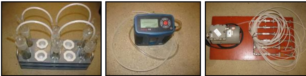
Figuur 2 Foto's van de natchemische meetmethode voor ammoniak. Links: twee sets van drie in serie geschakelde wasflessen. Midden: de flowmeter. Rechts: de elektropomp met zes pijpjes met een kritisch capillair
