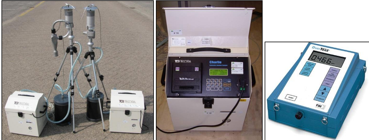
Figuur 1 Monsterapparatuur voor het meten van PM10 en PM2,5 d.m.v. gravimetrische filtratie. Links: een set apparatuur voor gravimetrische meting van PM10 (linker driepoot) en PM2,5 (rechter driepoot). Midden: detailfoto van de 'constant flow' monsternamepomp. Rechts: de DustTrak model 8520 voor continue/optische meting van PM10
