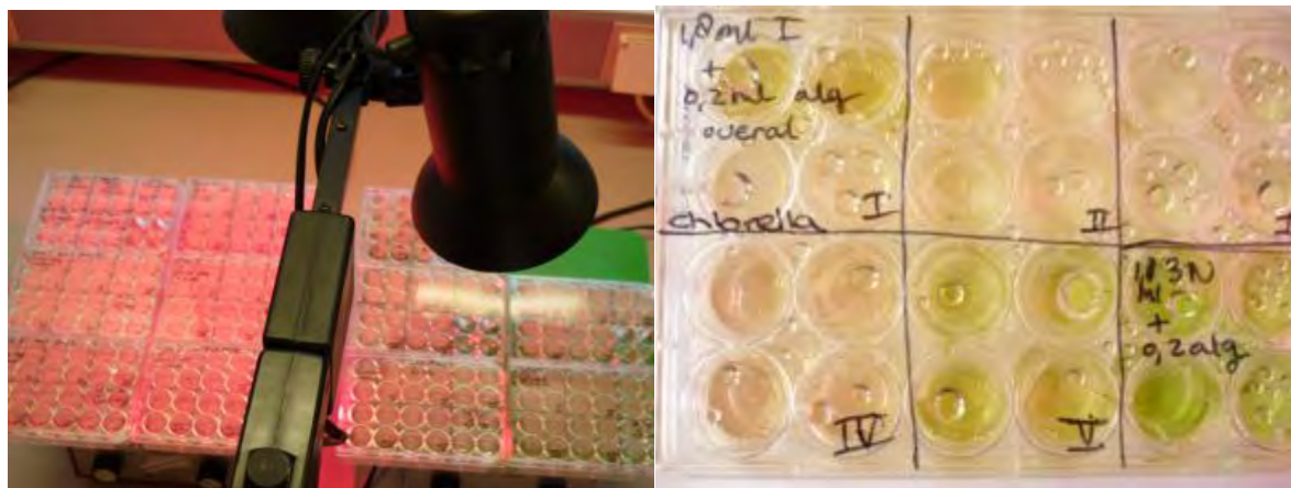
Figuur 1. Opstelling van de wellplaten op een schudder onder LED-verlichting (links) en voorbeeld van een wellplaat na 6 dagen incubatie (rechts).
