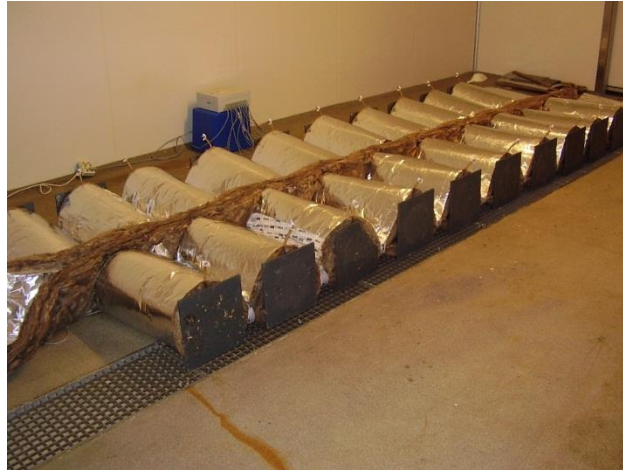
Afbeelding 1. Opstelling met minisilo's voorzien van PT100 thermokoppels en afgedekt met glaswollen dekens
