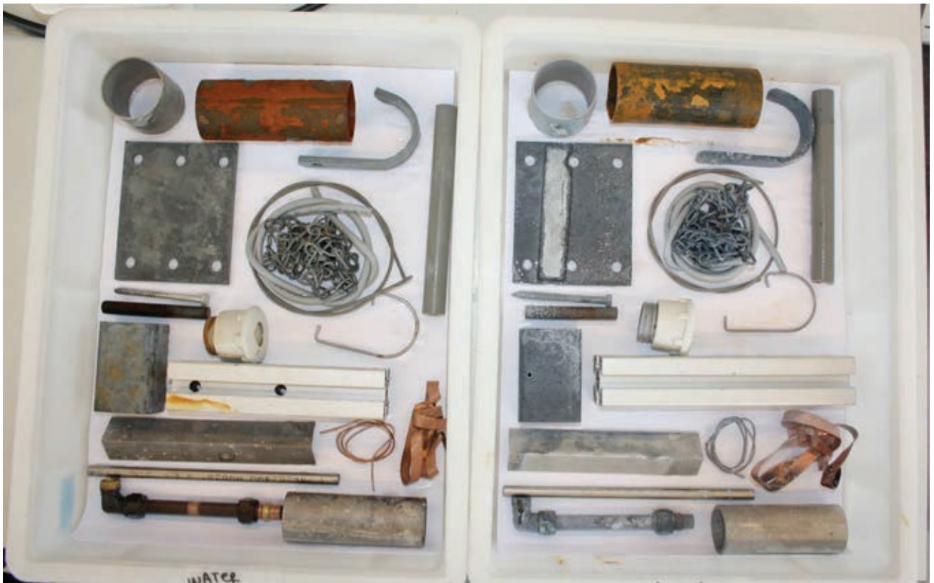
Figuur 11: Overzichtsfoto na 31 dagen onderdompeling in water (linker bak) of het oxidatief product (rechts). Verschillende materialen zijn uitgesteld in de bakken. Op een onverzinkt ijzeren buis (midden boven, rechts en links) is zware roestvorming zichtbaar in water (links) en het oxidatief product (rechts) na onderdompeling van 31 dagen. Een kleurverandering en witte was is zichtbaar op de overige materialen in de rechterbak (oxidatief product). Lichte roestvorming is zichtbaar op de overige materialen in de rechterbak (waterbehandeling).
