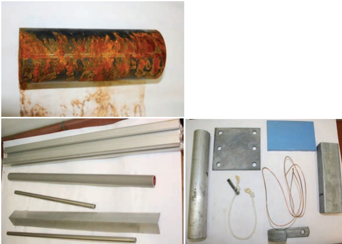
Figuur 9: Verschillende materialen na 24 uur onderdompeling in het oxidatief product. Materialen zijn o.a. aluminium, RVS en PVC (links onder) en verzinkt ijzer, koper en geanodiseerd aluminium (rechts onder). Linksboven is roestvorming zichtbaar op een onverzinkt ijzeren buis.
