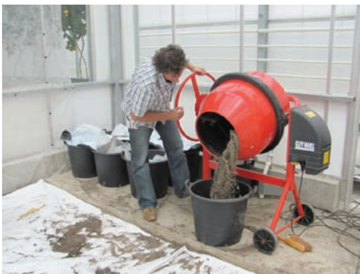
Foto nr. 2. De gezeefde kasgrond wordt in een betonmolen gemengd met rivierzand, op basis van een volumeverhouding van één op één.
