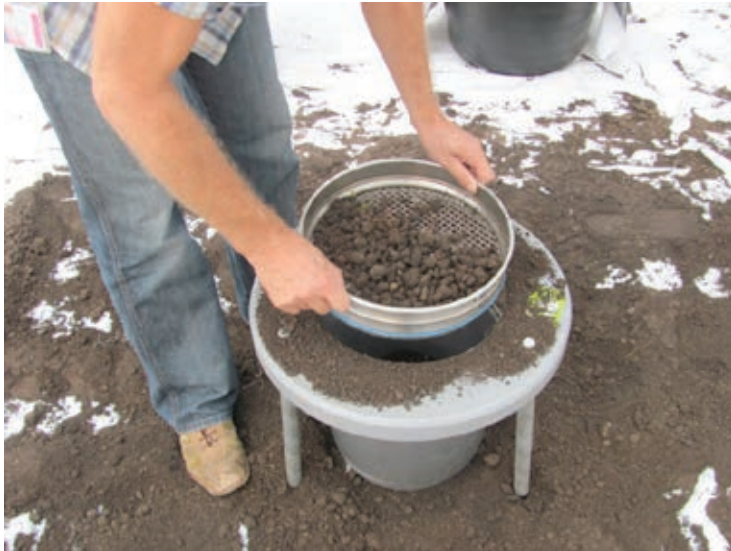
Foto nr. 1. De verzamelde kasgrond dat voor de kolommenproef is gebruikt werd eerst gezeefd door een zeef met een maasgrootte van 0,5 cm.
