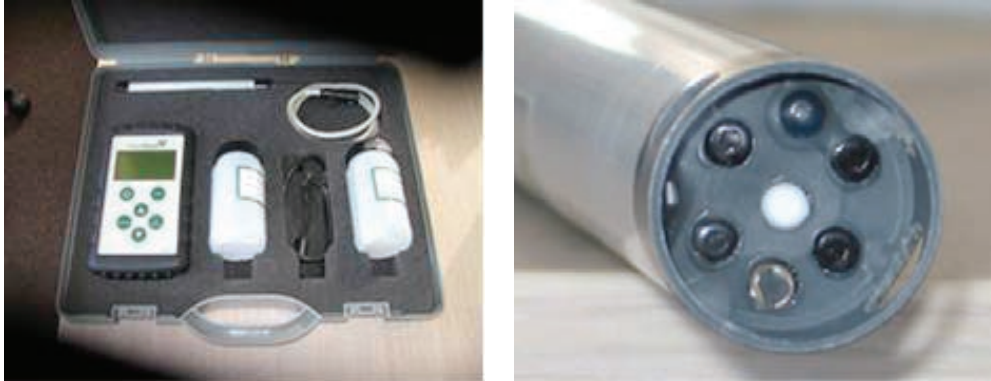
Foto 3. Links de portable ion specifieke meter van Clean Grow, bestaande uit een koffer met een ion selectieve electrode, een meet unit en flesjes met kalibratievloeistof. Rechts de meetkop van de ion specifieke meter van Clean Grow, met zes meetsensoren en een referentie sensor.
