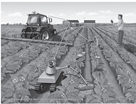
Figuur 5. Data verzamelen in het veld met sensoren.
