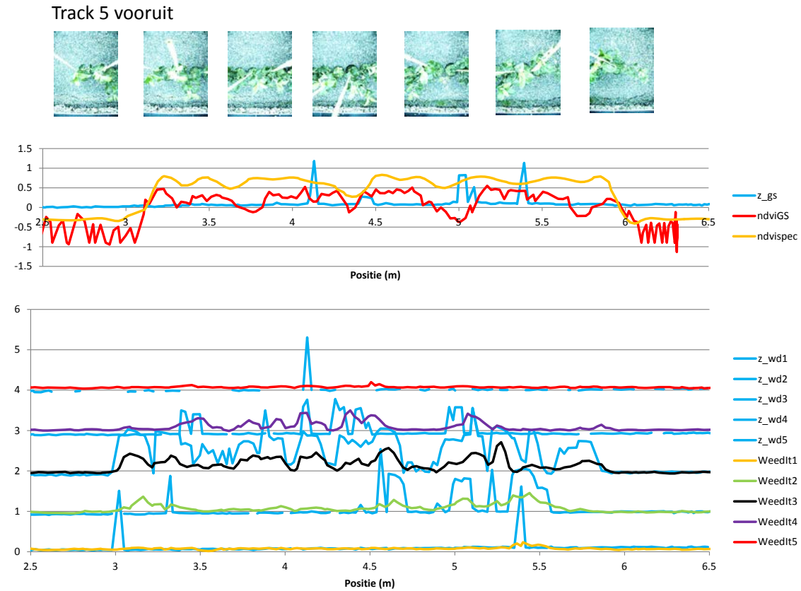
Figuur 7. Het resultaat van track 5 vooruit. De bomen hebben in deze meting dicht op elkaar gestaan. Boven in de figuur zijn de opnamen van de camera gegeven, daaronder de signalen van de GreenSeeker en de Spectrometer en daaronder de signalen van de signalen van de 5 WeedIt sensoren. Met een lichtblauwe lijn is in dezelfde figuur de hoogte gemeten door de laserscanner gegeven (vermeldt als z_xx). De hoogte is een gemiddelde hoogte met dezelfde kijkhoek als de bijbehorende sensor.
