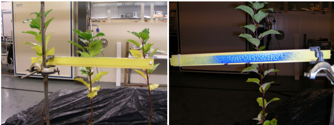
Figuur 15. Meetopstelling met watergevoelig papier om de bedekking van de scheuten door de spuitvloeistof vast te stellen. Links voorafgaand aan de bespuiting, rechts na de bespuiting.
