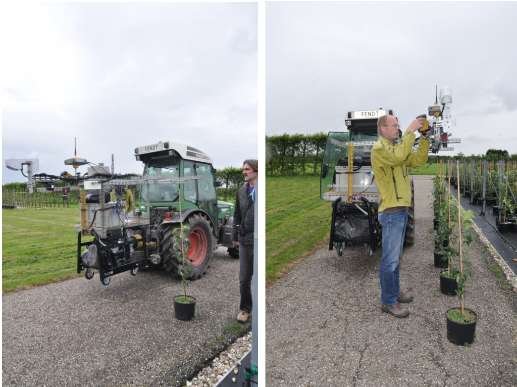
Figuur 2. Sensormast naar beneden gericht.
