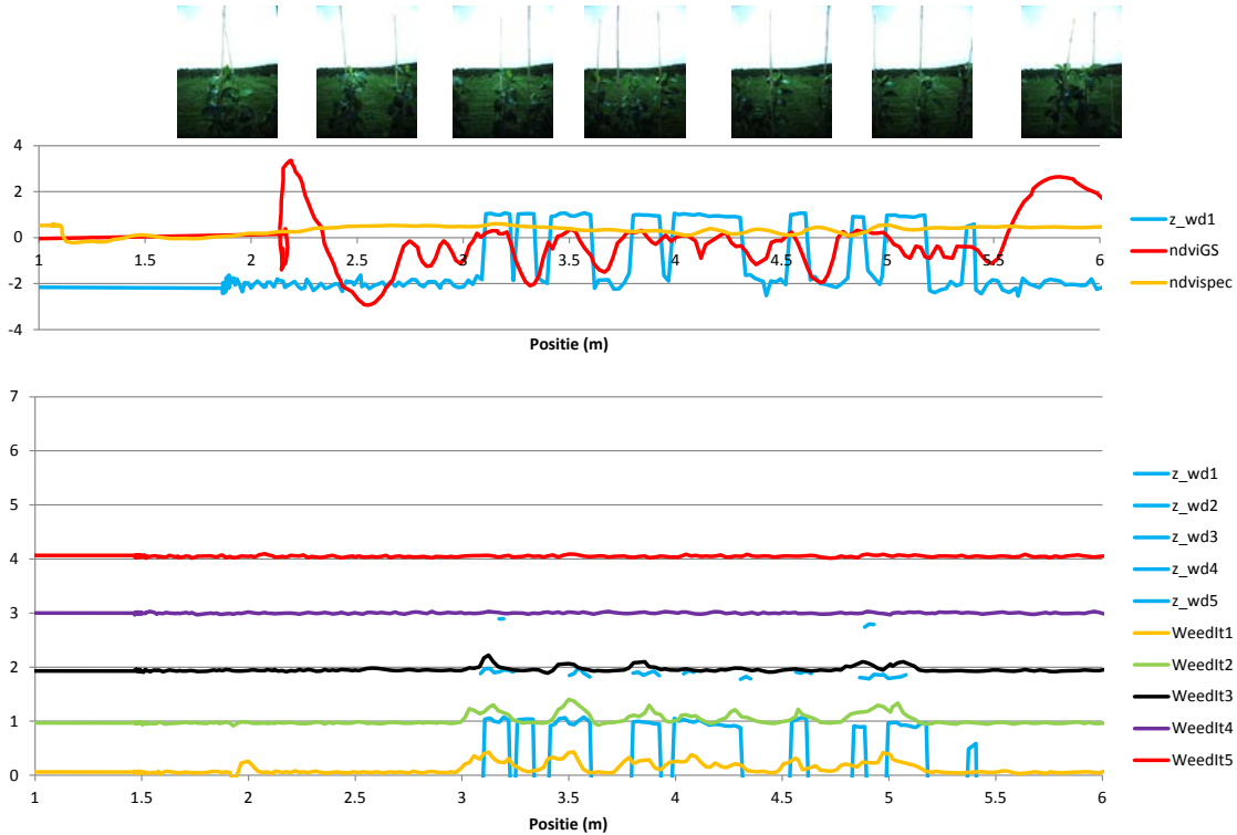
Figuur 8. Het resultaat van track 2 vooruit voor de zijwaartse meting. Boven in de figuur zijn de opnamen van de camera gegeven, daaronder de signalen van de GreenSeeker en de Spectrometer en daaronder de signalen van de signalen van de 5 WeedIt sensoren. Met een lichtblauwe lijn is in dezelfde figuur de hoogte gemeten door de laserscanner gegeven (vermeldt als z_xx). De hoogte is een gemiddelde hoogte met dezelfde kijkhoek als de bijbehorende sensor. De signalen van de Greenseeker en de Spectrometer geven geen duidelijk beeld door het achtergrond licht van de lucht. De signalen van de laserscanner zijn ook niet duidelijk omdat de bomen geen achtergrond meer hebben.
