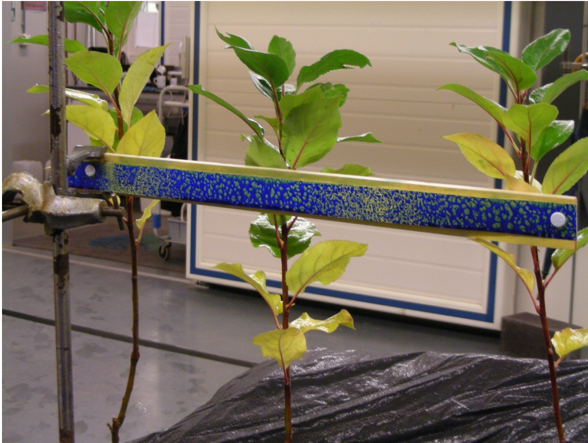
Figuur 16. Watergevoeligpapier is blauw gekleurd zodra er spuitnevel op komt. Door de relatief grove dop die gebruikt is en de hoge dosering tijdens de proef is bijna het hele papier blauw gekleurd. Te zien is dat de dop uitgeschakeld was tussen de scheuten in.
