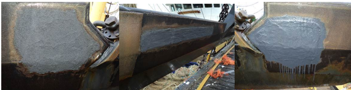
Figuur 11. Test van kunststof op de wing van de GO-09 – na 1 week vissen.
