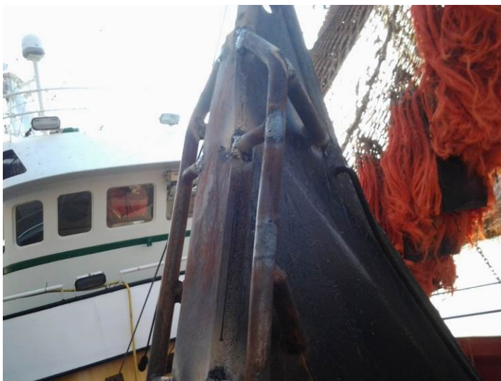
Figuur 48. Vastgelaste beugel met dwarsstukjes op de neus.
