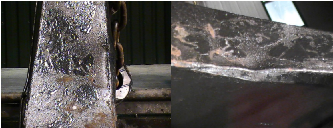
Figuur 45. Beschadiging van de neus van de wing.
