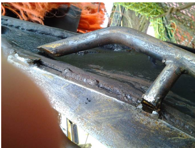
Figuur 46. Gebroken beugel aan de neus van de wing.
