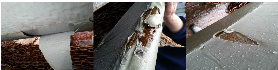
Figuur 13. Test van kunststof op de wing van de GO-09 – resultaat op 16/05/2012.
