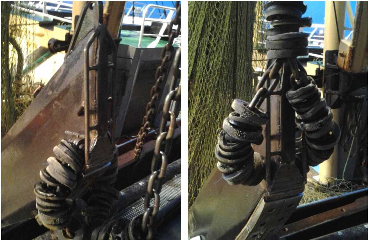
Figuur 47. Opgelaste beugel voor het gaan over onderzeese kabels op de neus.
