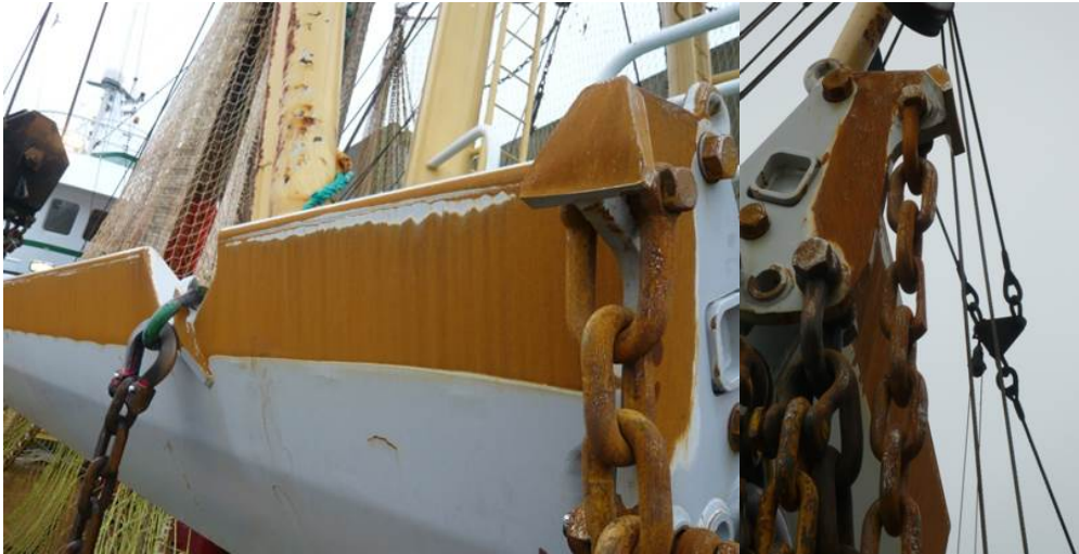
Figuur 7. Slijtage op de GO-31 aan de onderzijde van de wing (links) en aan de kop van de wing (rechts).
