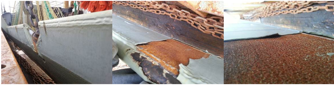
Figuur 14. Test van kunststof op de wing van de GO-09 – resultaat op 28/09/2012.
