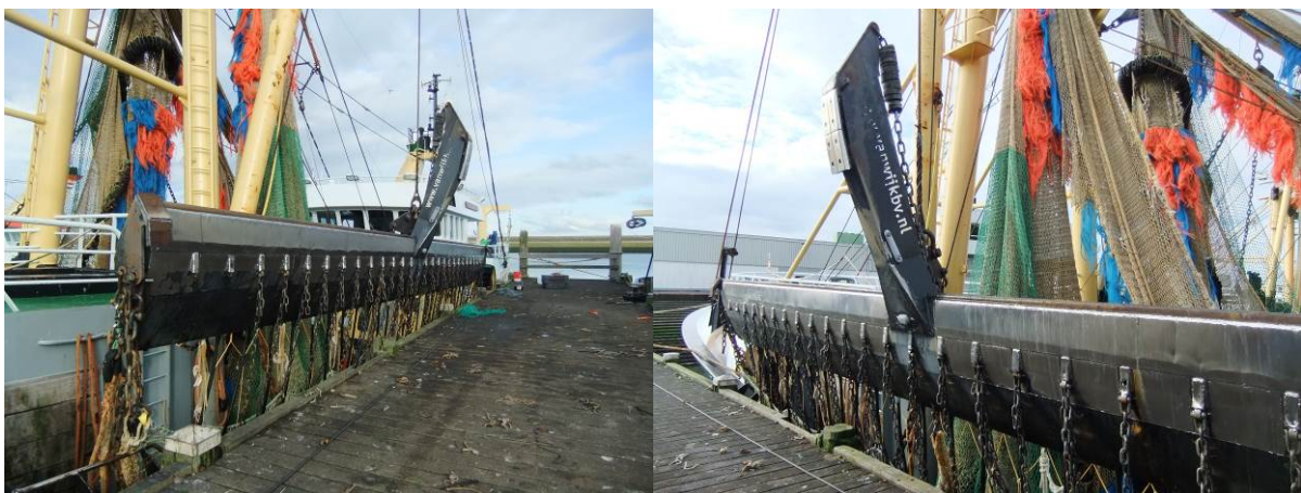
Figuur 16. Slijtage aan de PulsWing (Stellendam 30/11/2012, foto B. van Marlen)
