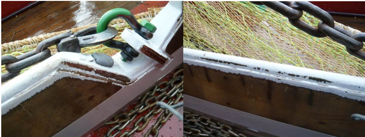
Figuur 8. Slijtage van verf op de wing (GO-31) – derde week.
