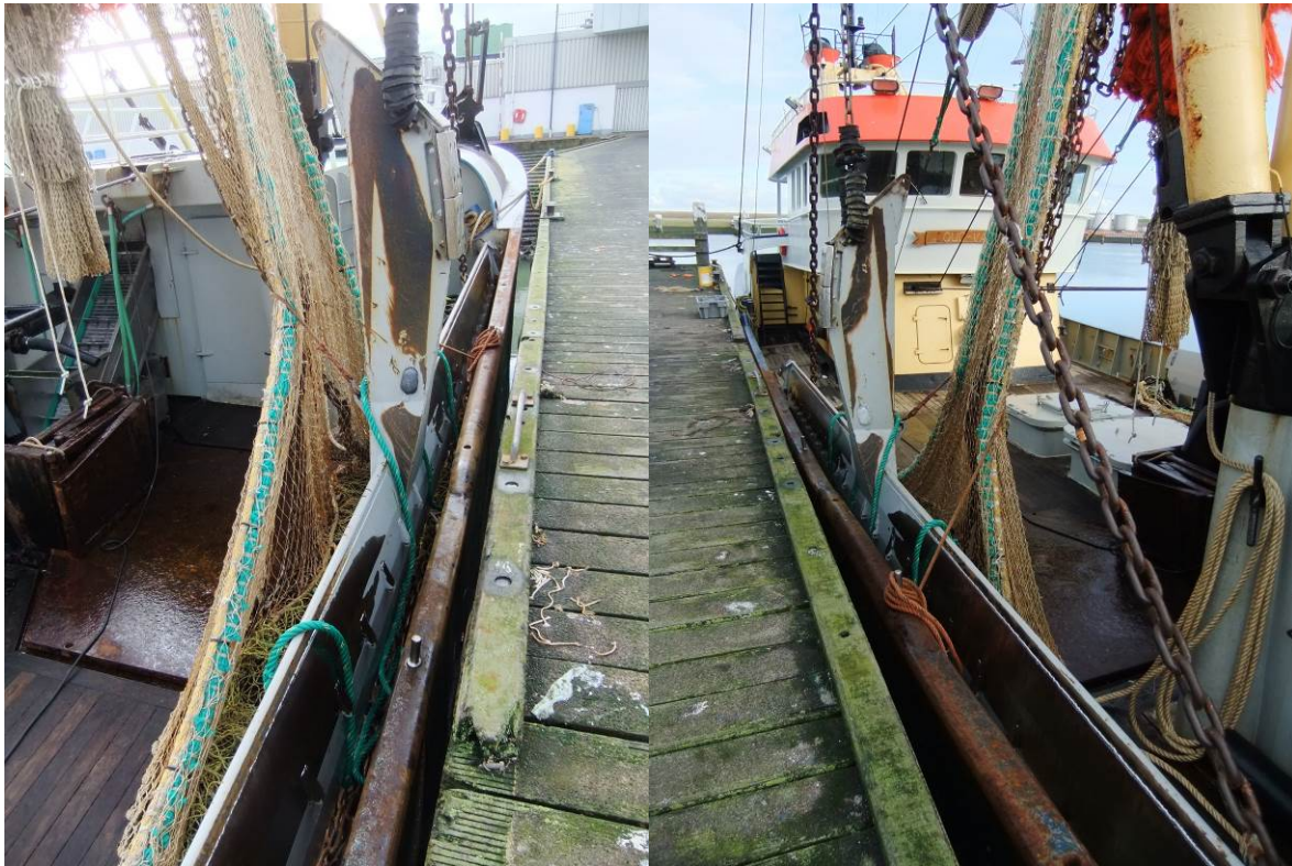
Figuur 17. Slijtage aan de SumWing (Stellendam, 30/11/2012, foto B. van Marlen)
