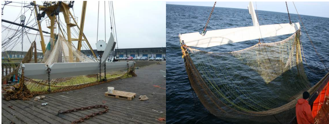
Figuur 2. Vleugel ('SumWing') van de GO-31, oorspronkelijke versie, rechts de ophanging van de langere bovenpees.
