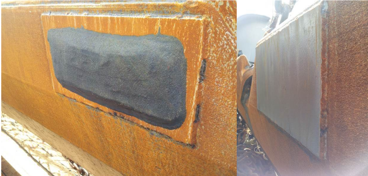
Figuur 9. Slijtplaten aangebracht op de wing van de GO-09 (19/09/2011). (Info firma Van Wijk B.V., te Stellingen).
