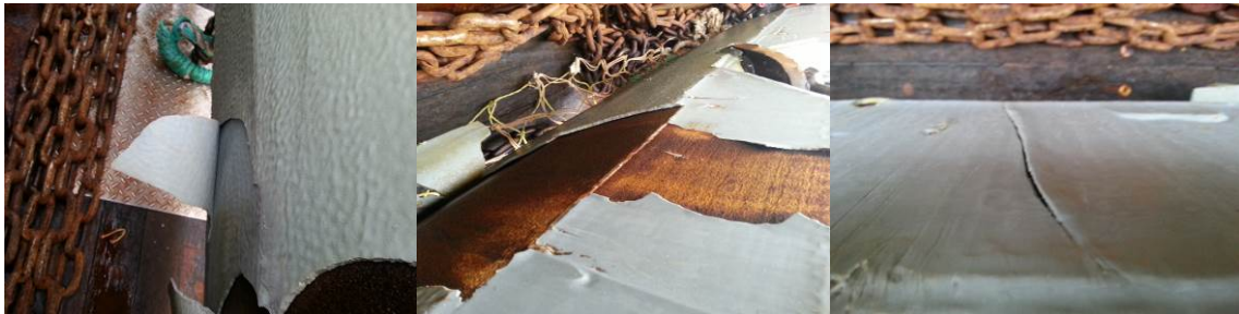
Figuur 15. Test van kunststof op de wing van de GO-09 – resultaat op 03/11/2012.
