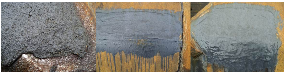
Figuur 12. Test van kunststof op de wing van de GO-09 – na 3 weken vissen.
