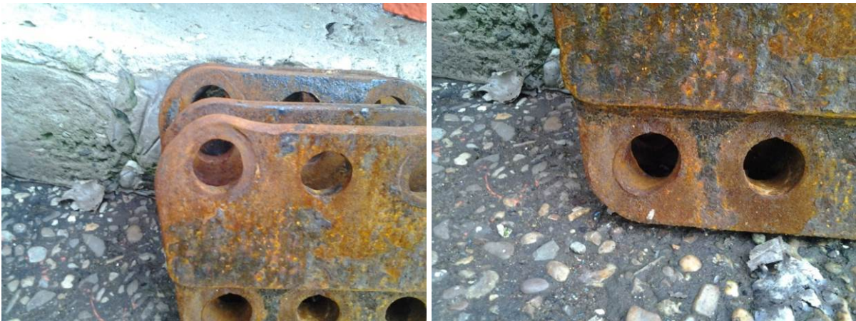
Figuur 49. Schade aan de ogen waar de spruit aan zit.
