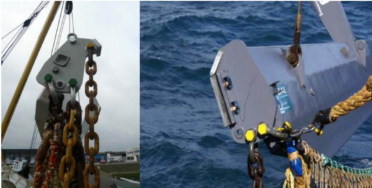
Figuur 5. Verbeterde koppen van de wing, links oude kop, rechts nieuwe kop.
