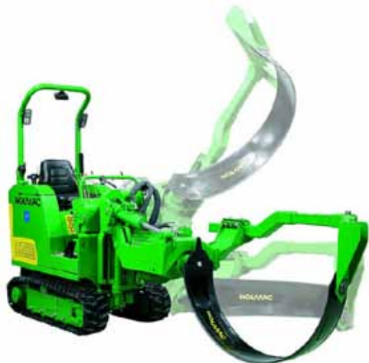
Figuur 3 Holmac HZC 32, een voorbeeld van een kluitenrooier met paraboolvormige messen.
