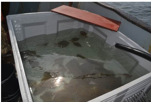
Figuur 12. Water toe- en afvoer in tub voor opvang van vis aan boord van de TH-10.
