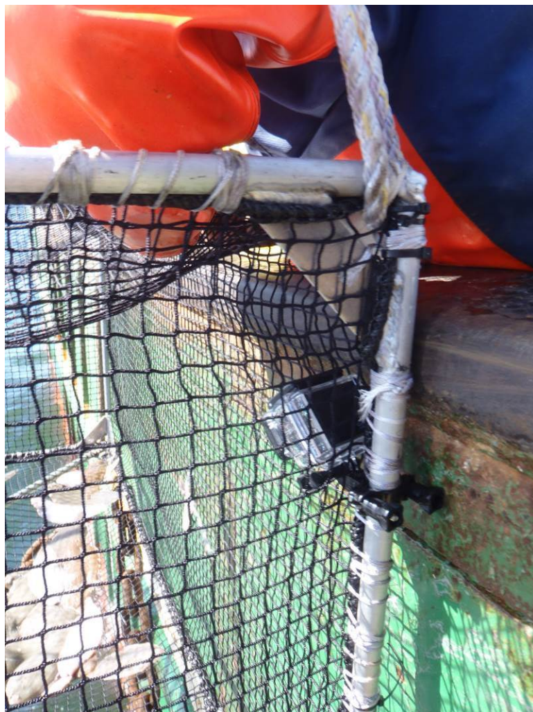
Figuur 4. Bevestiging camera in een onderwaterkooi in week 16 op de TX-43.
