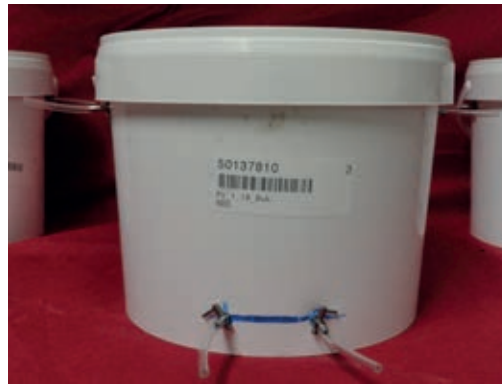
Figuur 18. en 19: Emmers in celproef, met aansluitingen voor metingen van omzettingsproducten van het proces.
