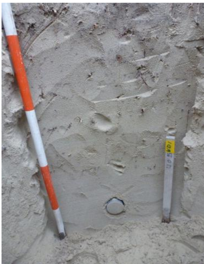
Figuur 4.2: Profielkuil WD-1 met onderin een in de wand geslagen pvc buis. Het zand dat hierin is verzameld is ter analyse aangeboden. De schaalverdeling van de chalon stok is 20 cm.
