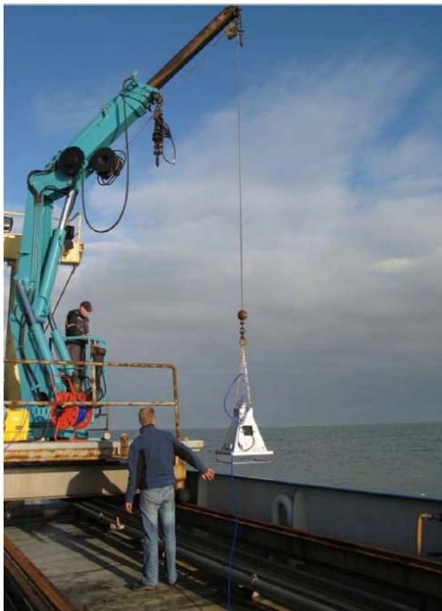
Figuur 2. Het camerasysteem gaat te water met behulp van een kraan.
