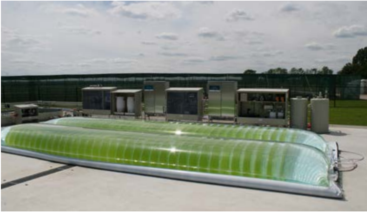
Systeem van plaatreactoren ingesloten in een grote waterzak. Ontwerp is van het Belgische bedrijf Proviron en deze demonstratiereactor staat bij AlgaePARC, Wageningen UR.
