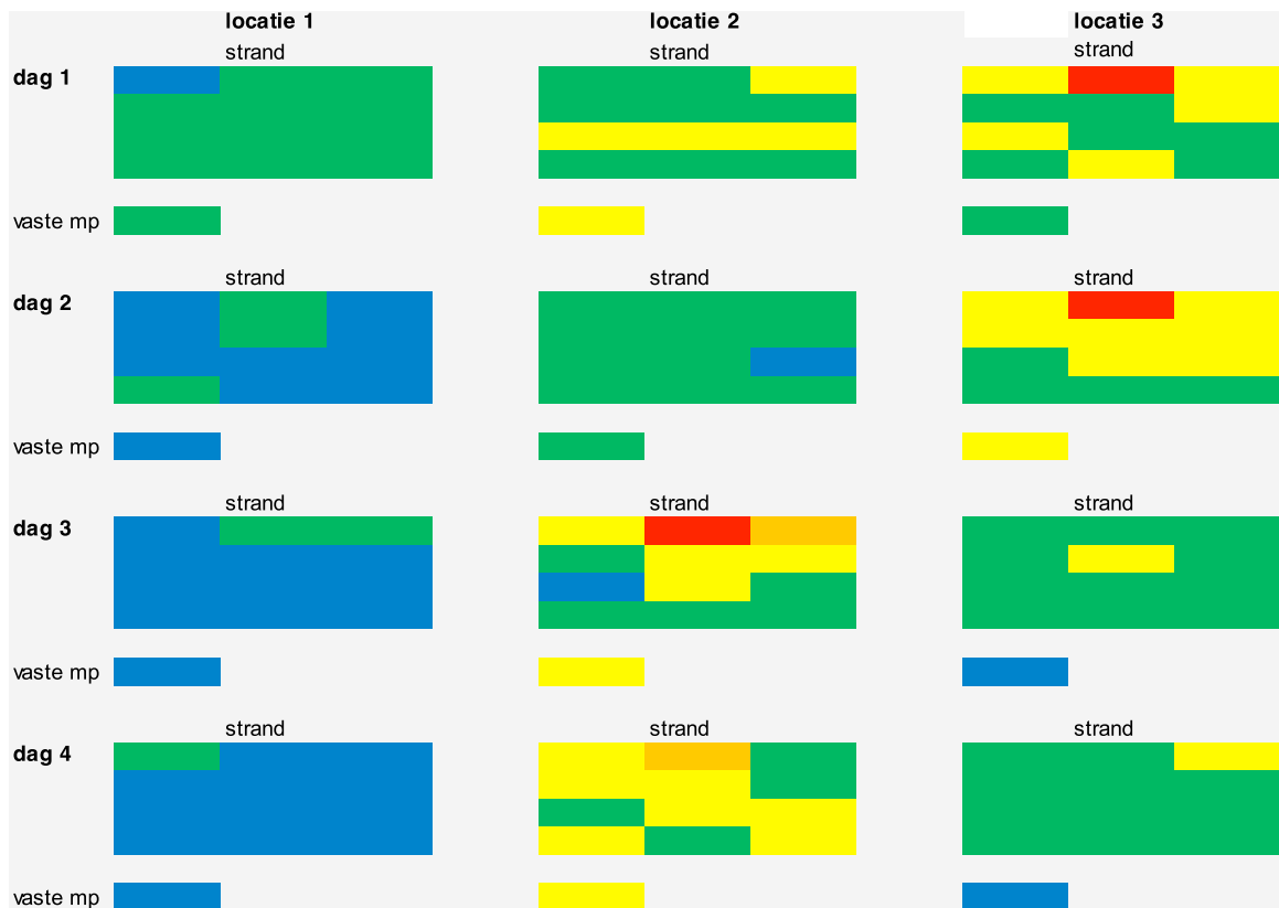
Afbeelding 2. E. coli -concentratie in grid vergeleken met het vaste meetpunt; blauw = onder detectielimiet, groen = 10 – 100 kve/100 ml, geel = 100-1000 kve/100 ml, oranje = 1000-2000 kve/100 ml, rood > 2000 kve/100 ml.
