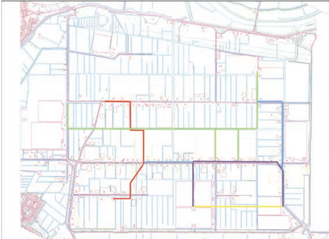
Figuur 11. Globaal traject warmte netwerken bron 1 (rood) en 2 (groen), verbinding Van den Bosch Wouters het kortste traject (geel) of aanzet tot netwerk (paars) en verbindingen tussen individuele netwerken (blauw) in de Koekoekspolder.
