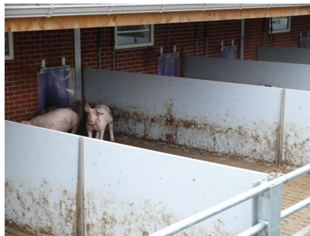
Foto 8 Uitloop bij de nieuwe stal met dichte tussenschotten en volledig rooster-vloer
