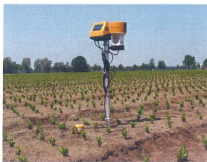
Dacomweerstation en vochtsensor actief in een Bukusperceel.
