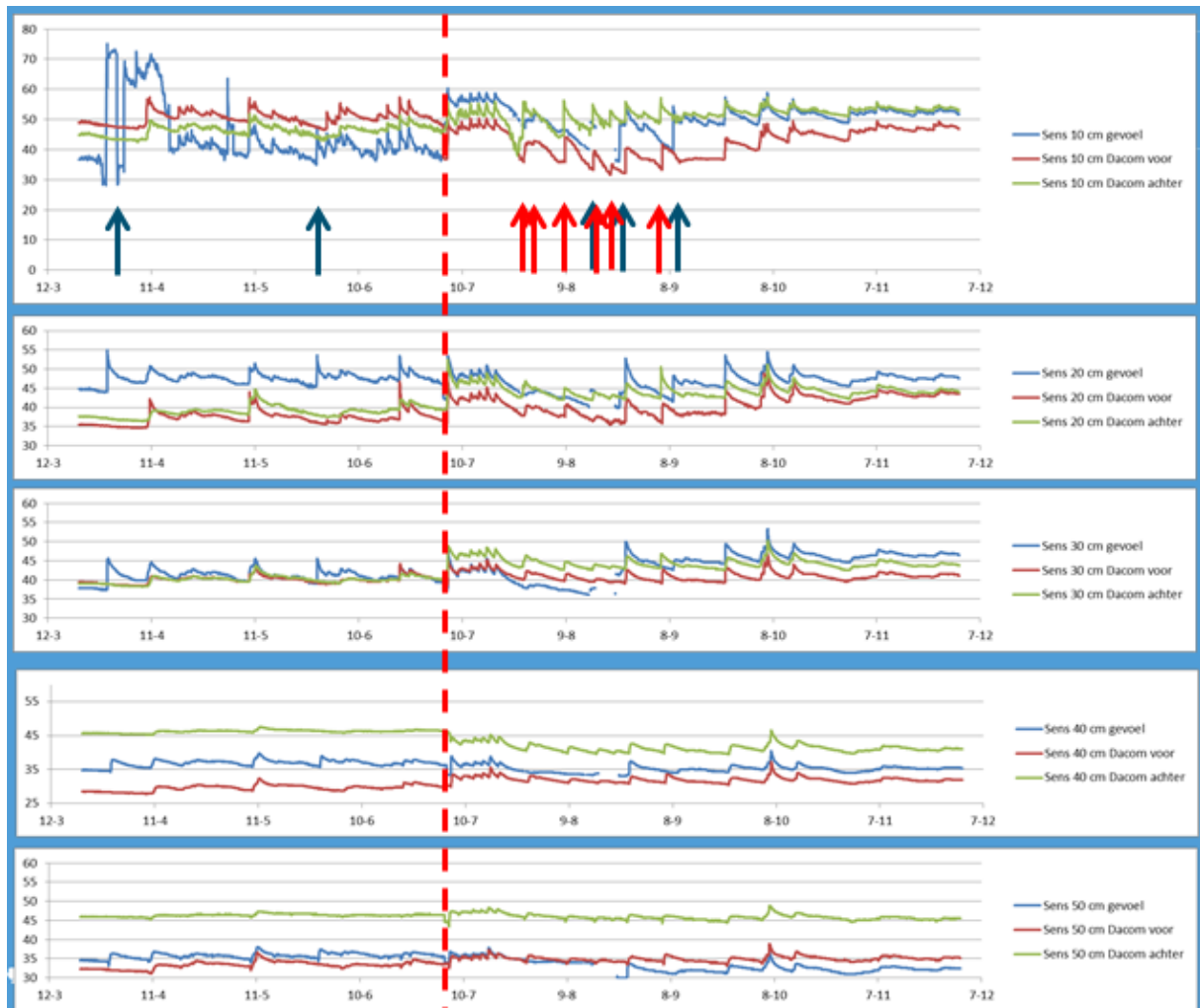
Figuur 26. Verloop van het vochtgehalte per 10 cm bouwvoor (0-50 cm) van drie TerraSen-sensoren in 2012 bij kwekerij De Buurte. Blauwe pijlen markeren beregening in behandeling 'gevoel'. Rode pijlen markeren beregening in behandeling 'Dacom'. De rode stippelijijn markeert moment van verplaatsen van sensoren.
