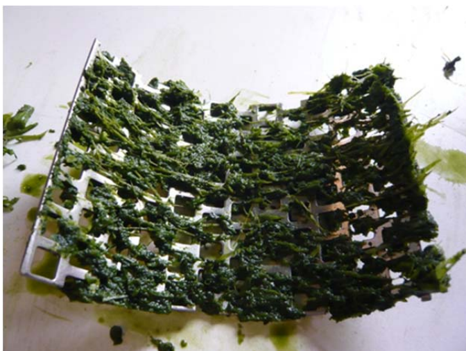
Figuur 11: Vers gemalen tomatenloof, dat blijft hangen in de zeef
