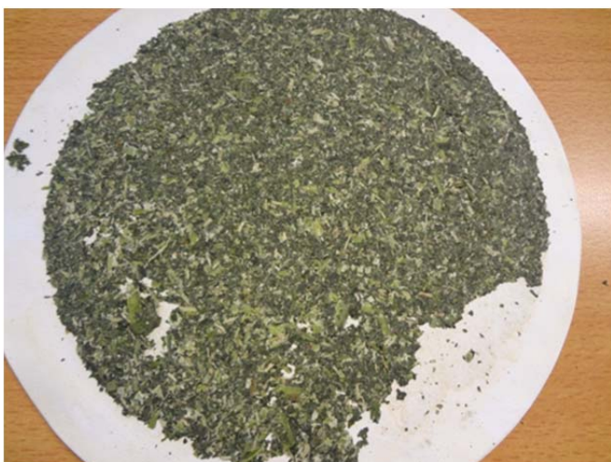
Figuur 12: Een proefvel van 100% vers gemalen tomatenloof
