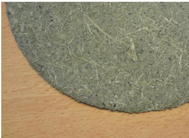
Figuur 13: proefvel van geëxtrudeerd tomatenblad
