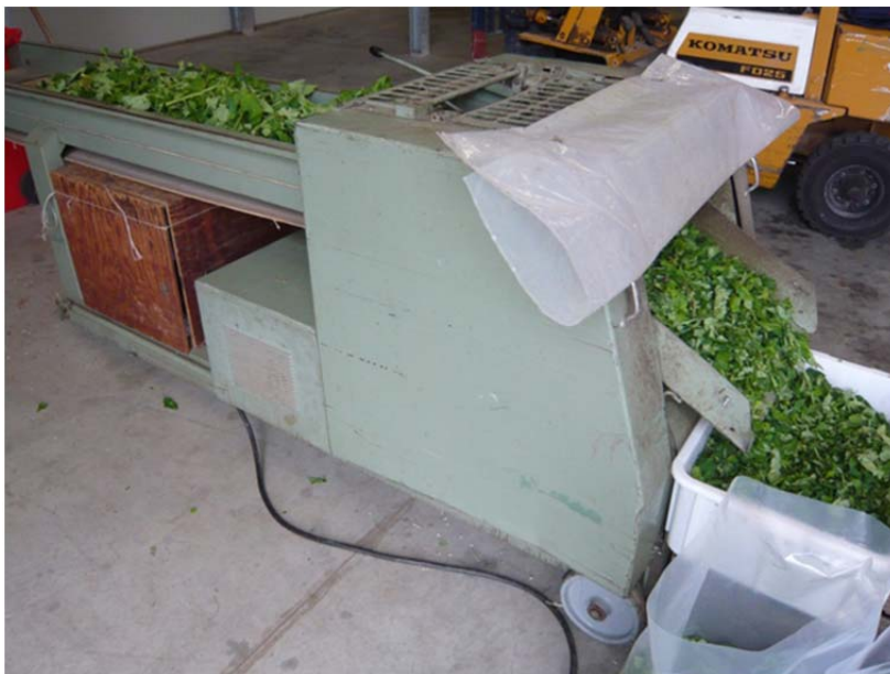
Figuur 1: De hakselaar waarmee het tomatenblad is voorgesneden
