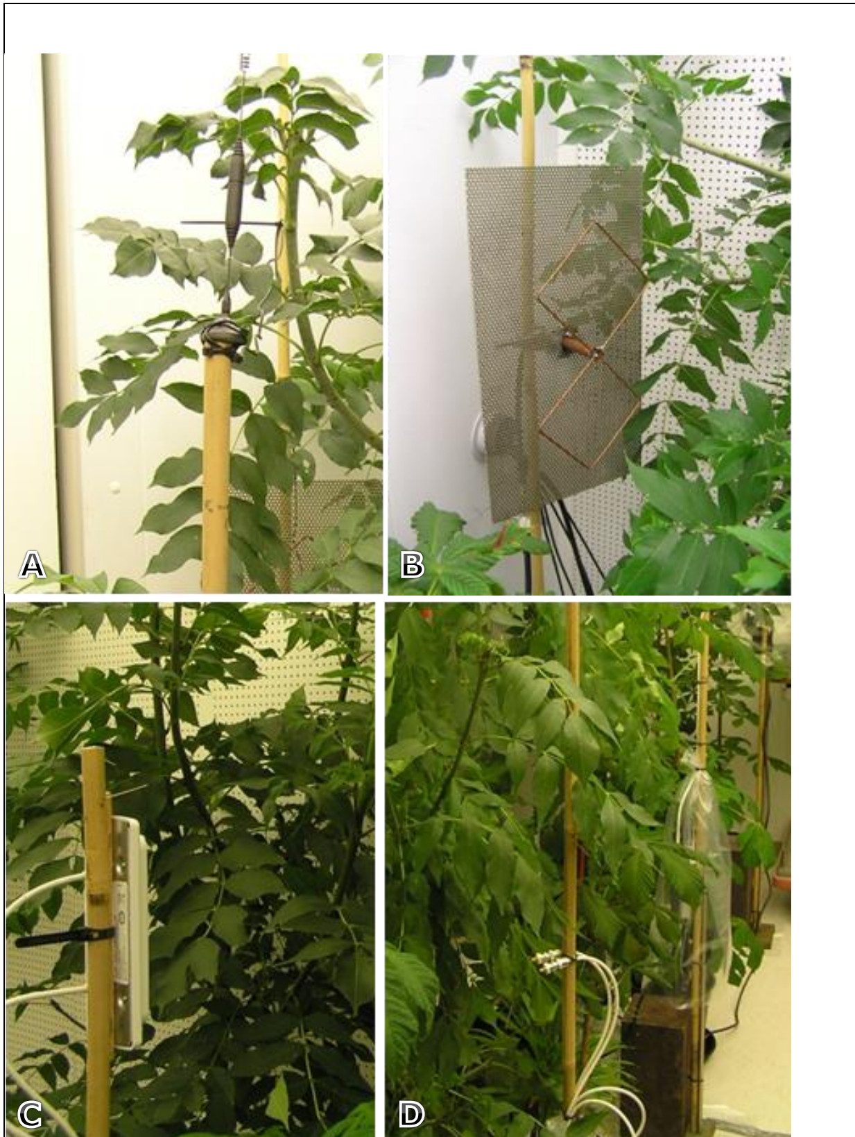
Fig. 12. A-C: Overzicht UMTS antenne, DVBT antenne, WiFi antenne (allen in klimaatcel C8) en D: Sham-opstelling voor WiFi in klimaatcel A1. (P8170007, P7040071, P7040063, P7040050)
