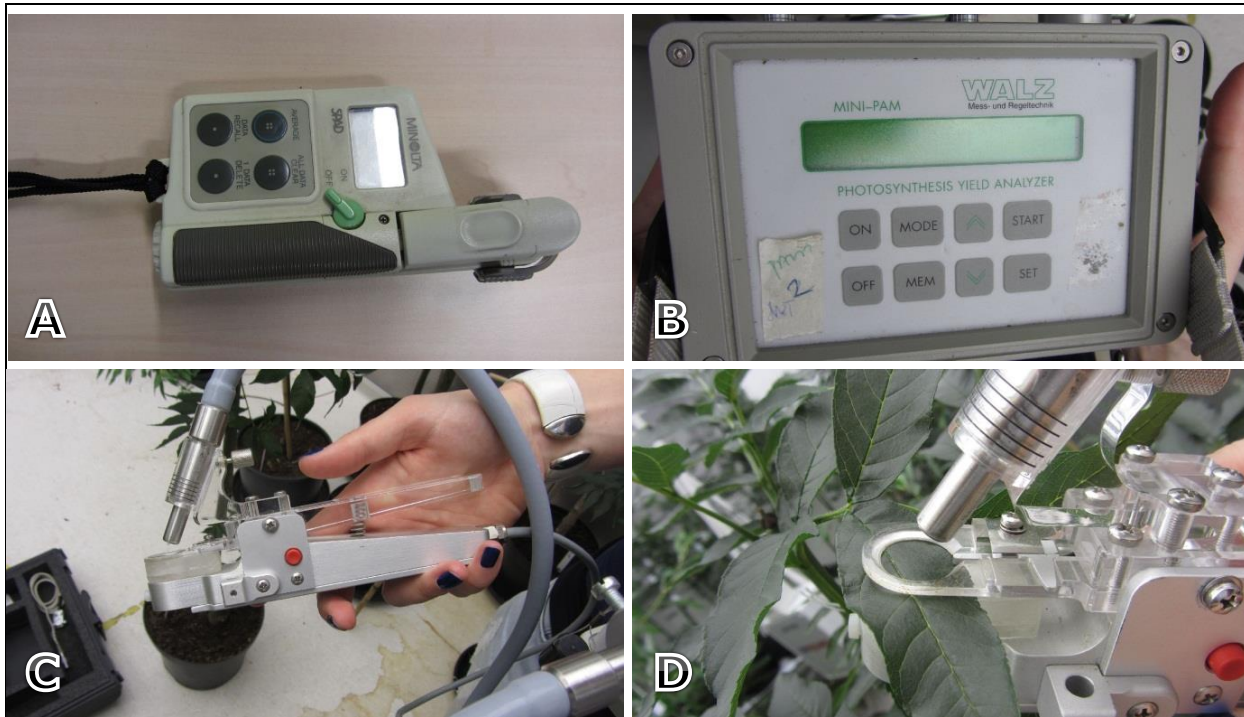
Fig. 13. Instrumentarium voor chlorophyllmetingen. A: SPAD-meter, B-D: Mini-PAM. Situaties op 2-6-2011. (IMG 0266, 3159, 3161, 3162)
