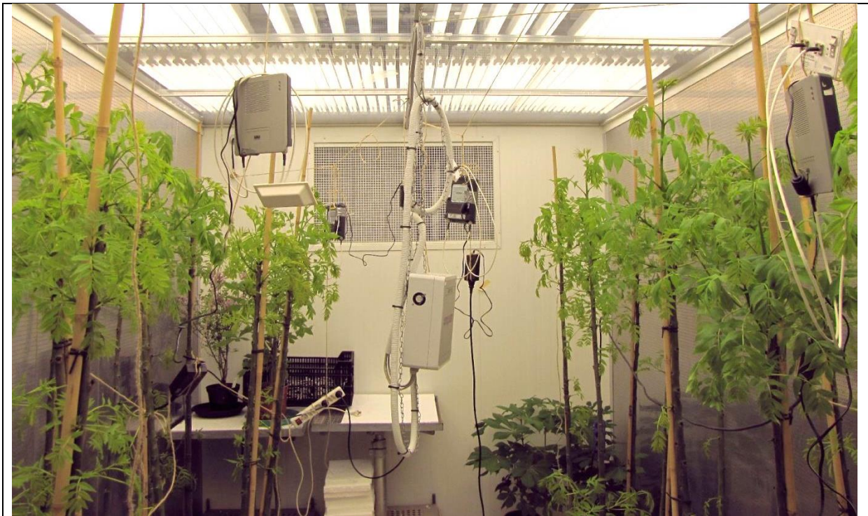
Fig. 3. Overzicht interieur klimaatcel A4 (+EM) met 6 WiFizenders en bijbehorende antennes waarvan 4 links- rechtsboven zichtbaar) bij begin experiment op 31-5-2010. IMG 6233
