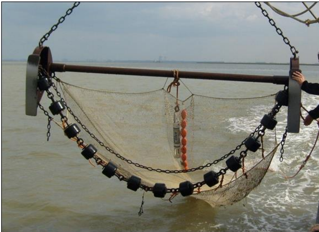
Afbeelding 4: Het DFS-net met klossenpees en wekkerketting.
