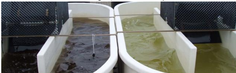
Fig. 6 Kweek in raceway op water gefiltreerd door 5 µm filter, en b, een raceway gefiltreerd over een 0,2 µm filter
