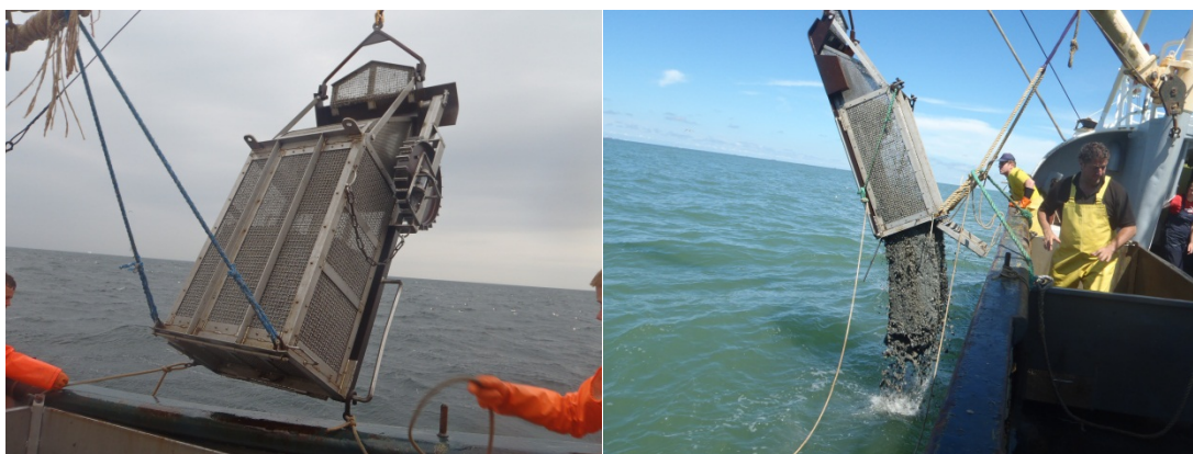
Figuur 5: De ingezette bodemschaaf met tellerwiel aan boord van de BRA7 (links). Een overvol en daardoor afgewezen monster wordt direct overboord gezet (rechts)
