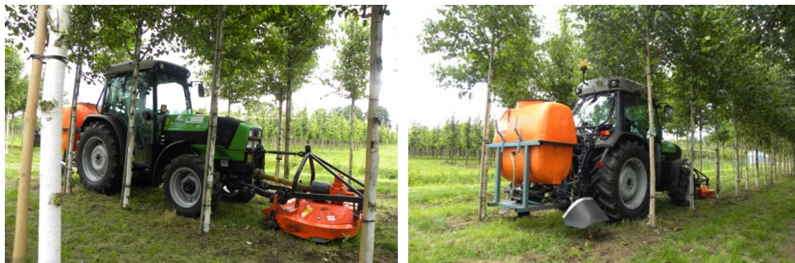
Figuur 7 Grasstroken maaien en chemische onkruidbestrijding in één werkgang
