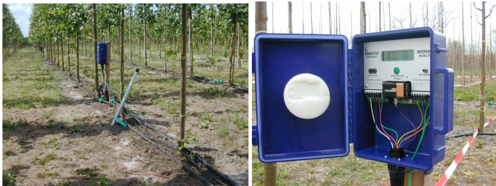
Figuur 4 Irrigatieveld, druppelslangen en watermarks (rechts datalogger)
