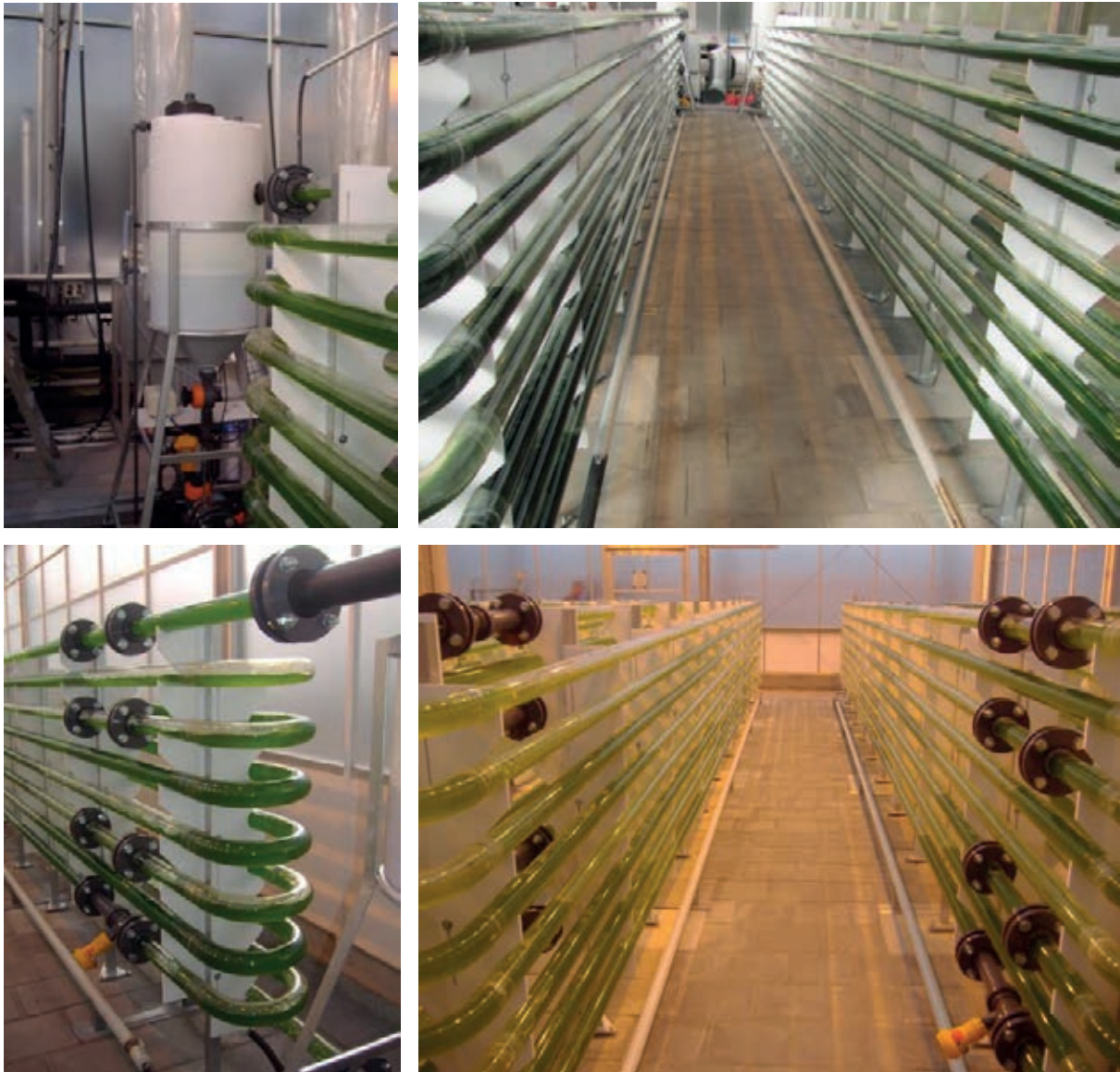
Figuur 2. Proeffaciliteit algenteeltsystemen in een kas bij Wageningen UR Glastuinbouw in Bleiswijk bestaande uit zes verticale algenbuisreactoren.
