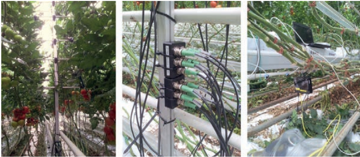
Figuur 3. De meetopstelling in de kas. Links de meetpaal met de Micro-Moni-PAM sensoren gemonteerd boven de goot tussen twee rijen planten. Midden de interfaceboxen gemonteerd aan de meetpaal. Rechts de mini-PC hangend onder de goot. De laptop op de goot werd alleen gebruikt voor de afregeling van de sensoren.
