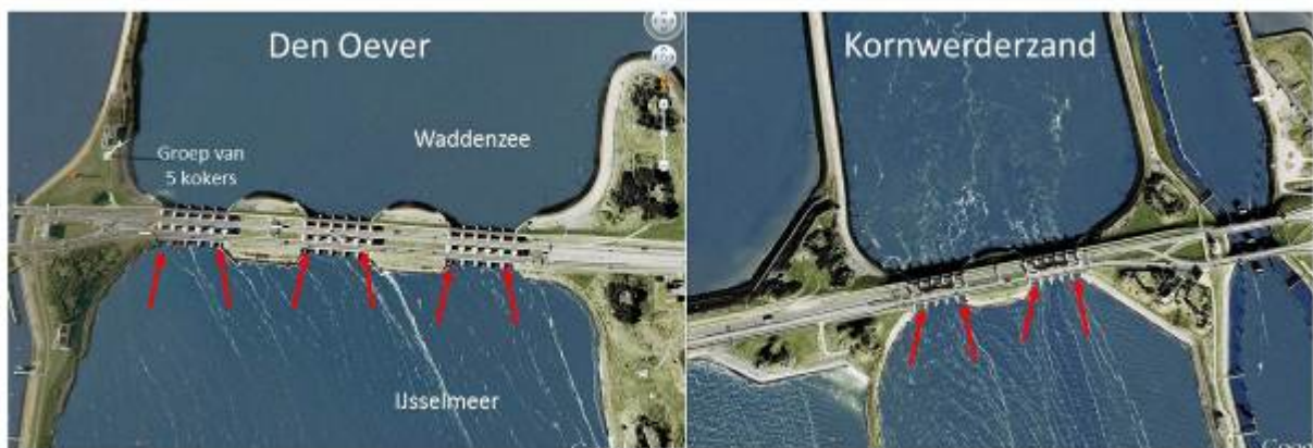
Figuur 3-2 Kaartjes met de spuicomplexen bij Den Oever en Kornwerderzand. Den Oever heeft drie groepen van vijf spuikokers en Kornwerderzand heeft twee groepen van vijf spuikokers. Bij de buitenste schuiven van elke groep van spuikokers (rode pijlen) kan aangepast spui-beheer worden toegepast, waarbij de schuiven op een 'kier' worden gezet. Een kier wordt gecreëerd doordat de schuiven maar gedeeltelijk worden opengezet en er ruimte ontstaat tussen de onderkant van de schuif en de bodem.
