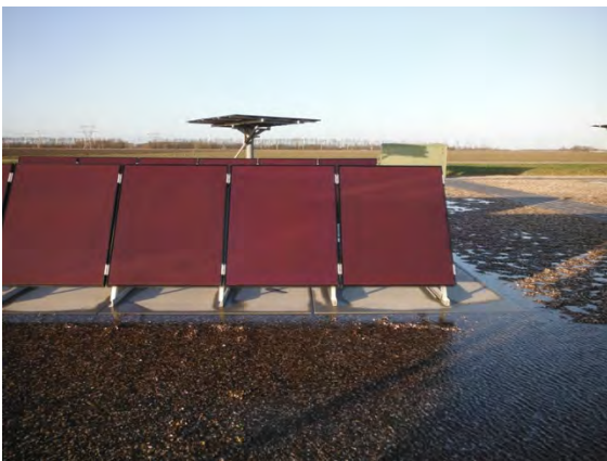
Foto 12: Geen schaduw van vaste op variabele Schott opstelling
