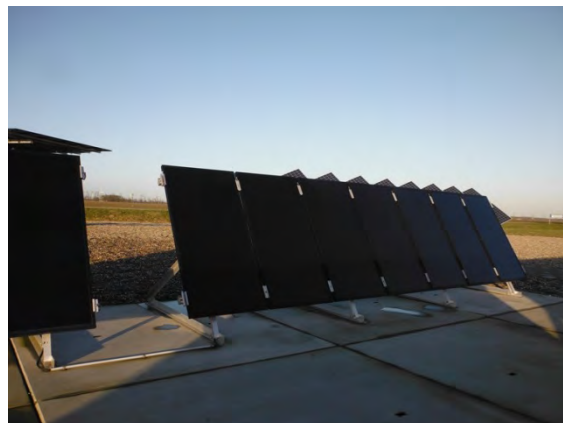
Foto 15: Schaduw van 1 e rij op 2 e rij variabele Sulfurcell opstelling
