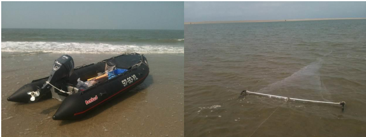
Foto 2: Links: 4,5 meter rubber boot Bombard C5 met 25 pk motor. Rechts: twee meter boomkor in de lagune.
