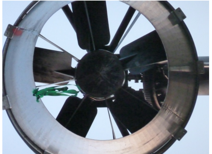
Afb. 3: Windmachine voor nachtvorstbestrijding op kruisbessenperceel in Slijk-Ewijk, voorjaar 2013.
