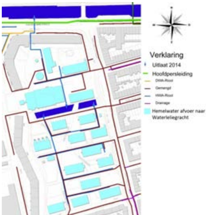
Figuur 11. Kaart met het hemelwaterrioleringsstelsel (blauw), De Haarlemmervaart (In donkerblauw boven), de Waterleliegracht (Donkerblauw, midden) en de gebouwen waarvan het hemelwater afvoert naar de waterleliegracht (Lichtblauw).
