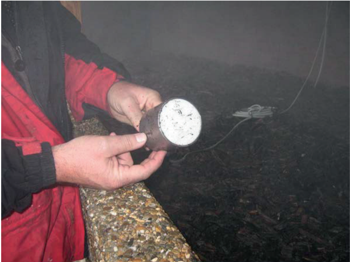
Figuur 2.6. Foto van de vochtigheidssensor (diëlektrisch meetprincipe); de sensor wordt enige centimeters onder het oppervlak tussen de houtsnippers geplaatst.
