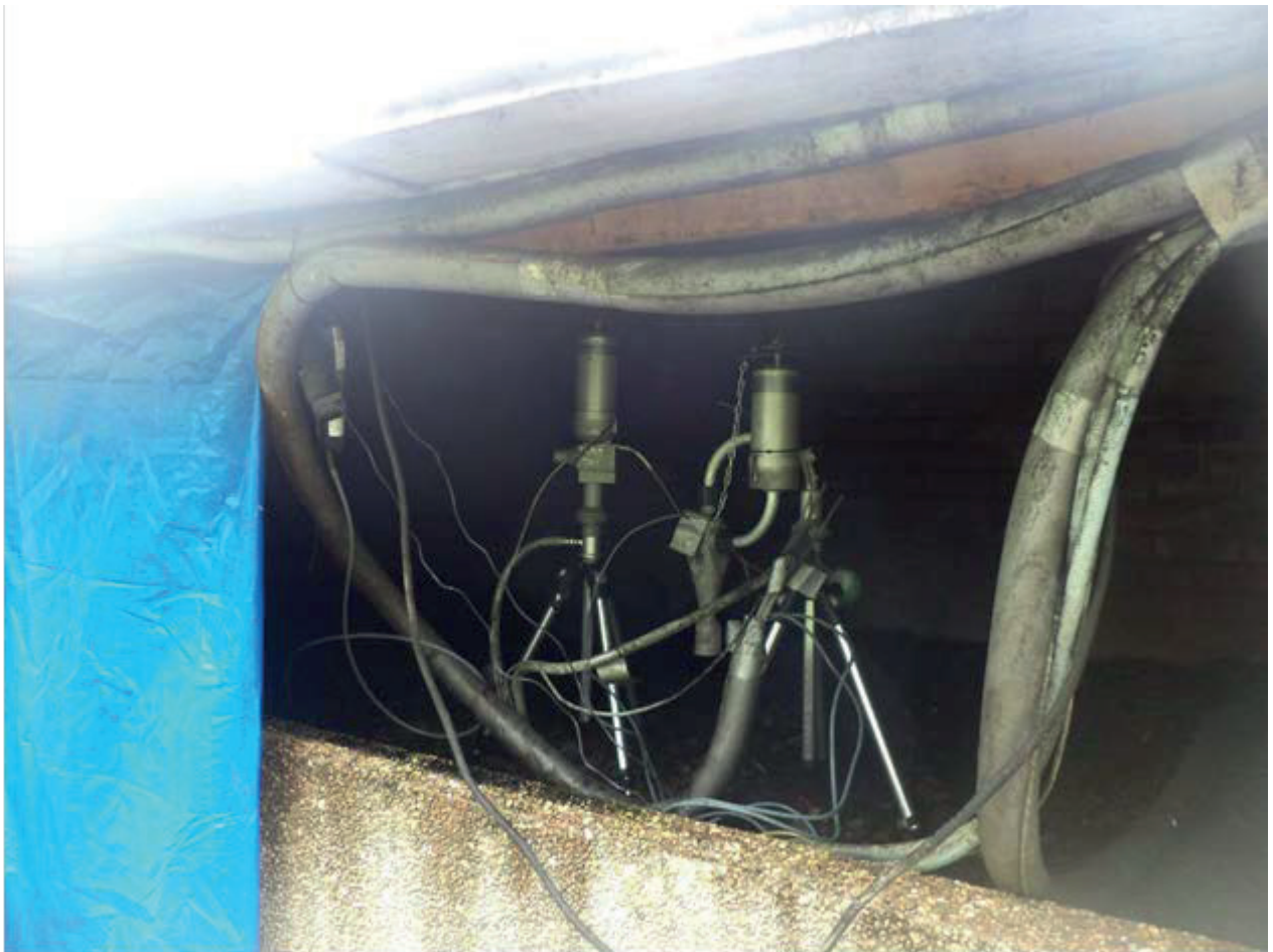
Figuur 2.8. Detailopname van de uitstroomopening in het midden van een van twee meetcompartimenten. Op de foto's zijn de monsternametekoppen (op statieven) te zien voor de fijn stofmetingen (zie Figuur 2.7 voor een overzichtsfoto).
