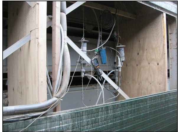
Meting in de gang aan de uitstroomzijde, tussen houten schotten ter voorkoming van windinvloeden van buiten. Aan de uitstroomzijde bestonden ook twee meetposities, eveneens op 1/3 en 2/3 van de lengte van de droogtunnel
