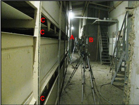
Meting in de drukkamer aan de ingaande zijde, zowel op 1/3 als 2/3 van de lengte van de droogtunnel (meetposities A en B ). De foto is genomen tijdens meting 2: de droogtunnel is nog in originele situatie (geheel open instroomspleten: C )
