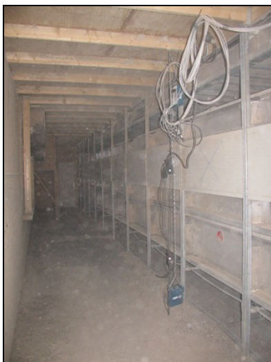
Meting van de ingaande lucht in de drukkamer, zowel t.h.v. de bovenste als onderste instroomopening
