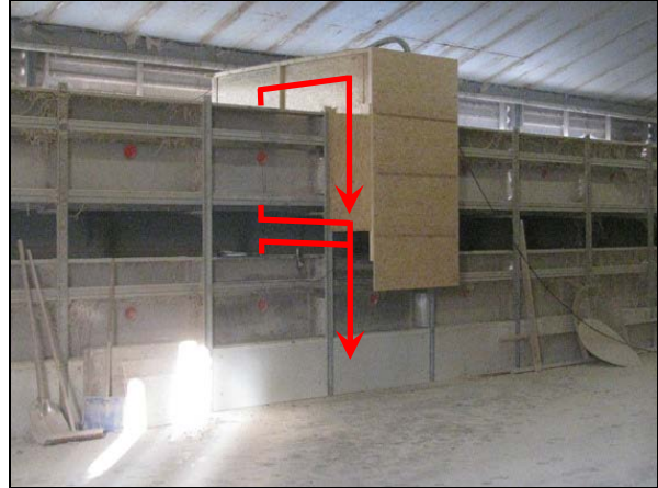
Vooraanzicht van de droogtunnel met houten meetopstelling, welke de uitgaande lucht uit de droogtunnel (zowel uit band 1 van boven als uit banden 2+3+4 door de centrale opening) langs het uitgaande meetpunt forceert. De luchtstroming is met pijlen aangegeven
