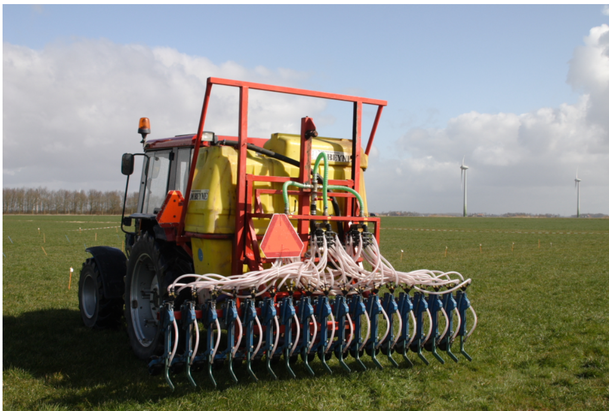
Figuur 1 Proefveldmachine voor de toediening van vloeibare meststoffen.
