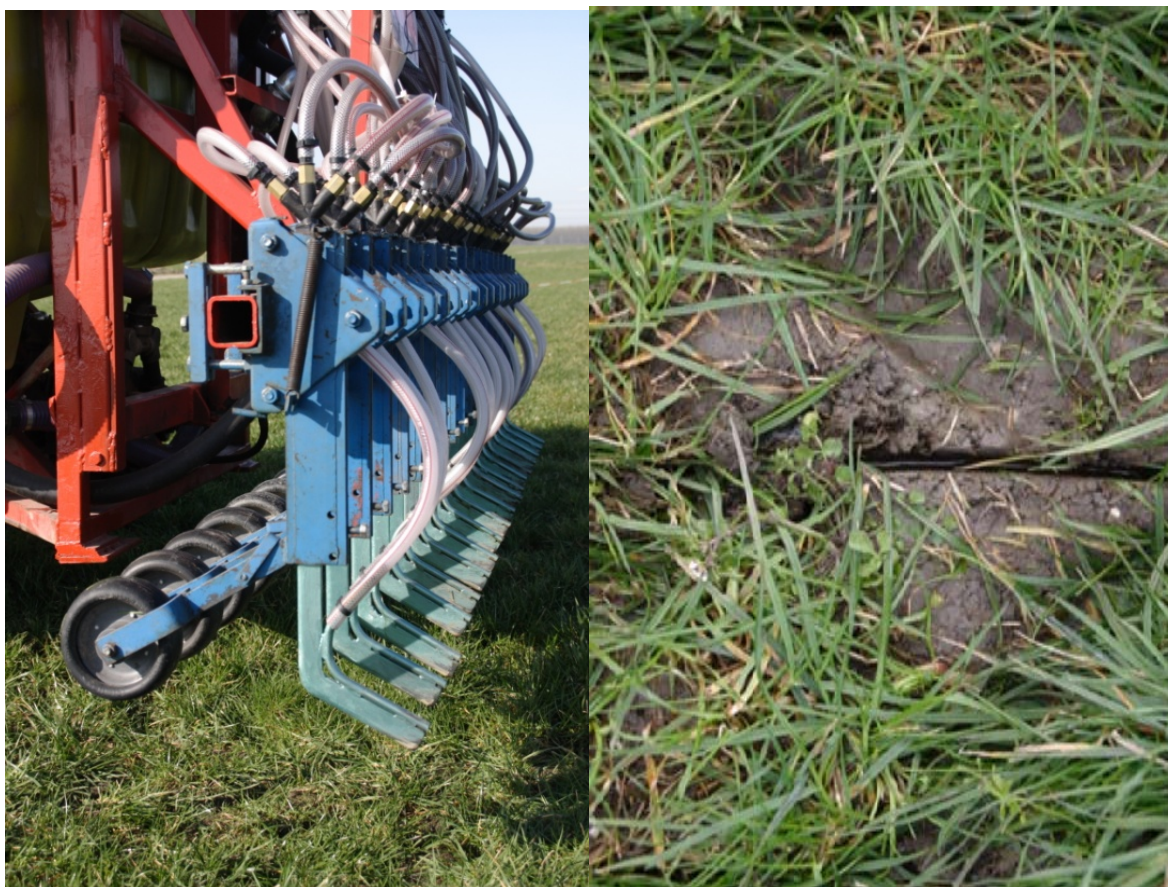
Figuur 2 Kouter van proefveldmachine en sleuf in graszode
