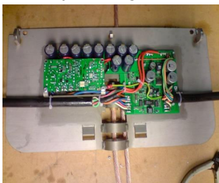
Figuur 2.4 Basisplaat module met gemonteerde elektronica.
