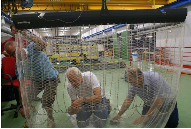
Figuur 2.2 Stelwerk aan de strengen en de onderpees van het schaalmodel pulswing te Boulogne.
