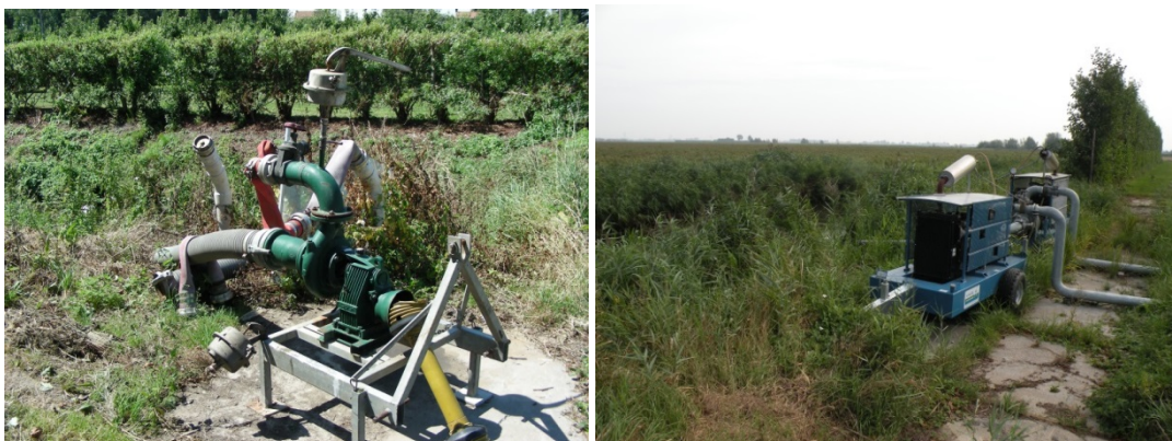
Figuren 5 a,b: beregeningspompen voor oppervlaktewater.
