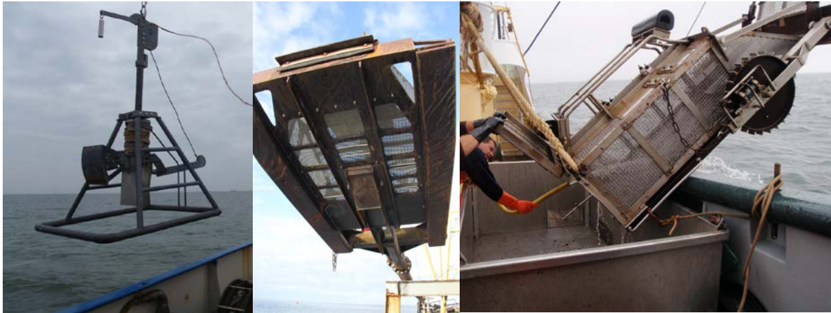
Figuur 3. Gebruikte monstertuigen: van links naar rechts: boxcorer, zuigkor, bodemschaaf
