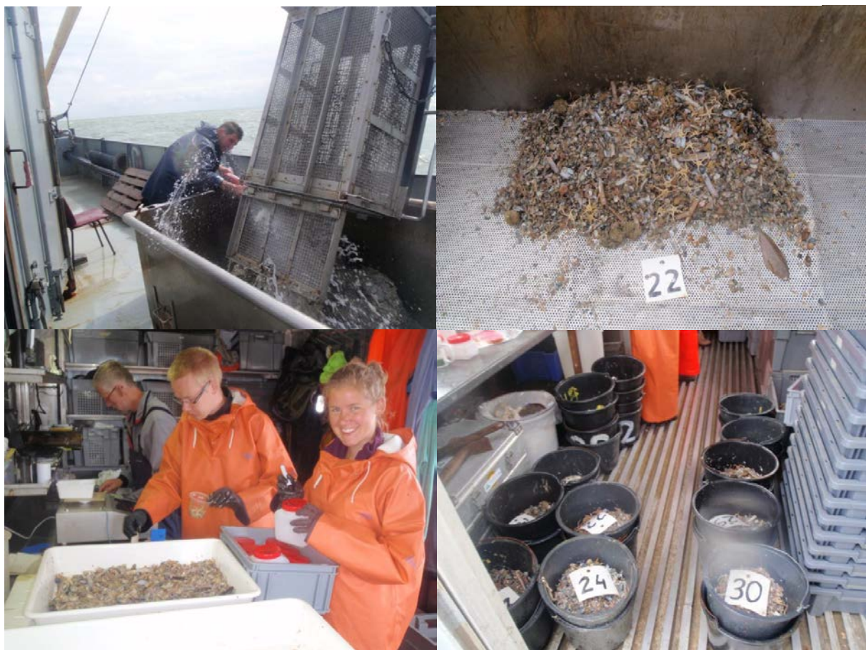
Impressie van benthos veldwerk. Linksboven met de klok mee: bodemschaaf komt aan boord; voorbeeld van een monster; een serie monsters klaar om verwerkt te worden; het uitzoeken van de monsters.
