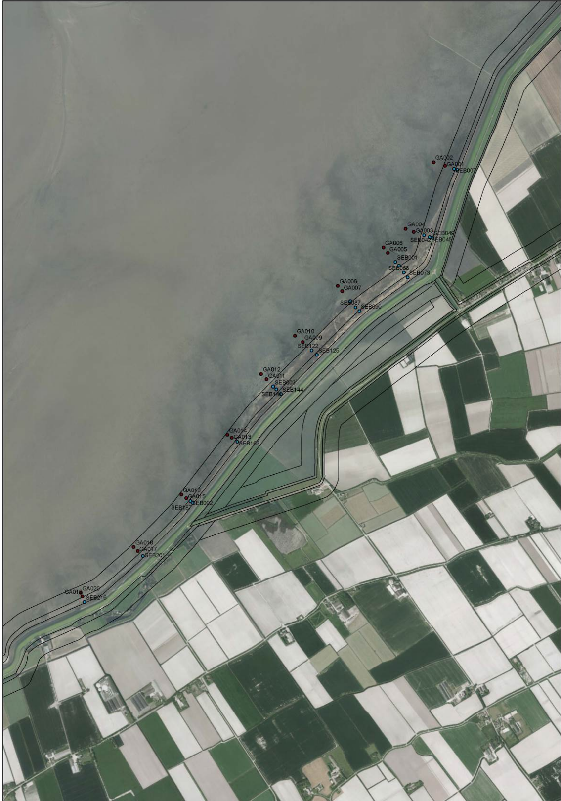
Figuur 6. Beoogde locaties van de Sedimentatie-Erosie Balken en grondankers. Blauwe stippen zijn posities van SEBs, rode stippen zijn posities van grondankers.
