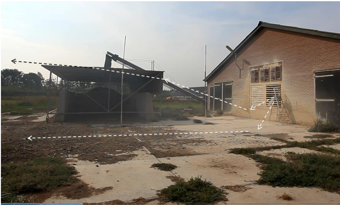
Figuur 8. Een beeld uit de rookproeffilm. De rookgenerator is in het midden van de grote rechter ventilator geplaatst. Een bewegend beeld geeft beter aan hoe de rook zich verspreidt. Daarom is hier met stippelijntjes schematisch aangegeven hoe de rook zich verspreidde.
