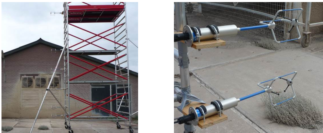
Figuur 7. Een overzicht van de windmeters op de verschillende hoogtes terwijl de kleine ventilatoren aan staan (links) en een detailopname van de windmeters (rechts).
