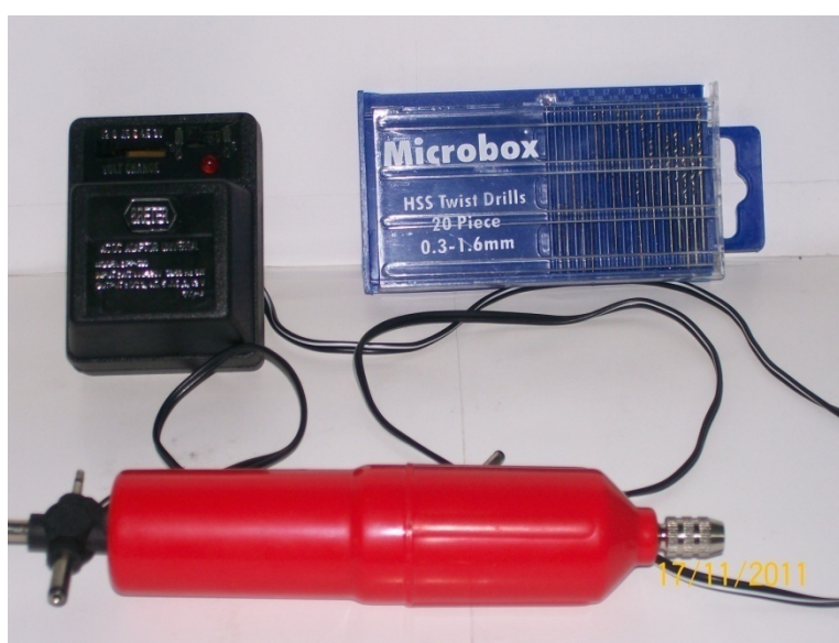
Gambar 4. Alat bor mini untuk pengambilan sampel ^{13}\text{C}
