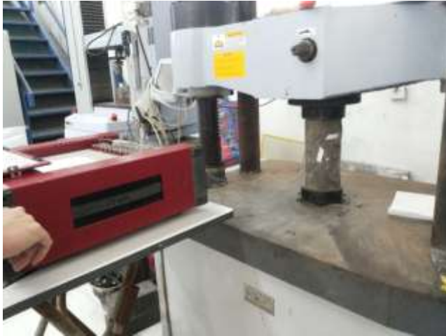
Gambar 4. 20 Pengetesan Modulus Elastisitas
