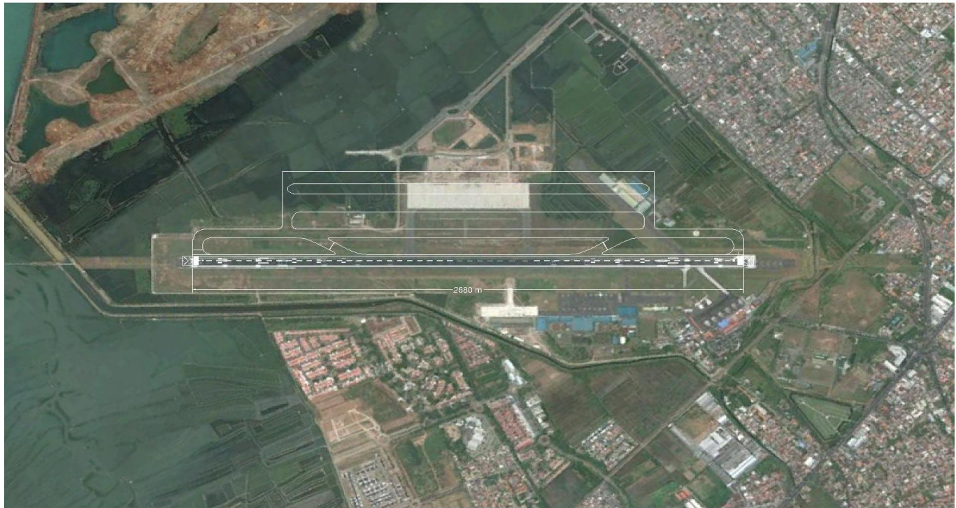
Gambar 27. Hasil Plotting Perencanaan Fasilitas Sisi Udara Pada Layout Bandara Ahmad Yani
